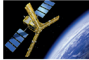
ILUSTRACIÓN 6: EJEMPLO DE UN SISTEMA SOLAR FOTOVOLTAICO, INSTALADO EN UN SATELITE
