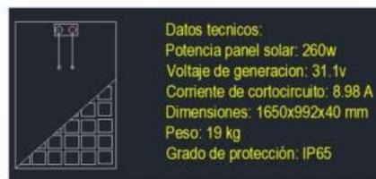
Debemos destacar la especificación del cable principal del generador, sección y tipo y los datos técnicos de los paneles y sus cajas de conexión, indicando su grado IP.
