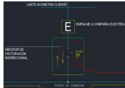
En el tipo de empalme es necesario indicar la potencia, corriente nominal, curva y capacidad de la protección del medidor.
