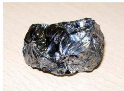
**Silicio:** en la actualidad, es el material semiconductor más utilizado para la fabricación de celdas fotovoltaicas
