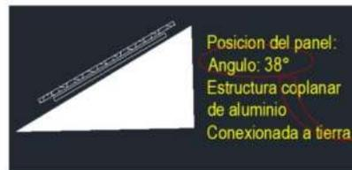
Destacar el ángulo de inclinación de los paneles.
